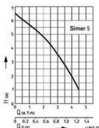
**Technische Daten:** 230 V, 50 Hz, 3,5 A, 400 W, 10 m Anschlussleitung (auswechselbar) mit Stecker, voll überflutbar, IP 68, Rotorwelle aus Edelstahl, integrierter Überlastungsschutz, Gleitringdichtung, für Dauerbetrieb geeignet, robustes Aluminiumgehäuse mit Einbrennlackierung, Gewicht, ca. 5 Kg, Schlauchanschlüsse 1/2", 3/4", 1"/(13/19/ 25 mm), nicht für salzhaltige Medien geeignet
